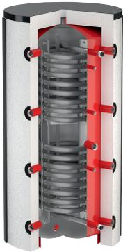
Speicher zur Kombination mehrerer Heizsysteme wie Feststoff-, Öl- bzw. Gaskessel und Wärmepumpen in Verbindung mit hygienischer Trinkwassererwärmung im integrierten, großflächigen Edelstahlwellrohr-Wärmetauscher. Pufferteil innen roh und außen mit temperaturbeständiger Beschichtung. Fußhöhenverstellung für schnelles und sicheres Ausrichten. Robuste und montagefreundliche Konstruktion. Solare Heizungsunterstützung über externen Wärmetauscher möglich.
