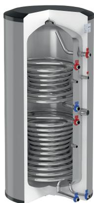
Indirekt beheizter Edelstahlstandspeicher mit zwei fest eingeschweißten Glattrohrwärmetauschern zur Trinkwassererwärmung. Montagefreundliche Konstruktion. Kombinierbar mit allen modernen Heizungsanlagen. Ausgerüstet mit Anschlüssen für Thermometer und Temperaturfühler/Thermostat.
