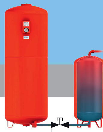
Anschlussschema Flexcon Vorlagebehälter
