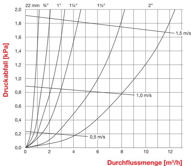
Dank der innovativen Konstruktion der Luft- und Schlammabscheider dieser Smart-Serie beschränkt sich der Druckverlust in der Anlage auf ein Minimum. Selbst bei Strömungsgeschwindigkeiten von 3 m/s erzielt die Smart Serie die besten Ergebnisse. Der hohe Wirkungsgrad garantiert die optimale Funktion der Heizungs- oder Kühlanlage. Mit dem nebenstehenden Diagramm läßt sich einfach die benötigte Größe ablesen.
