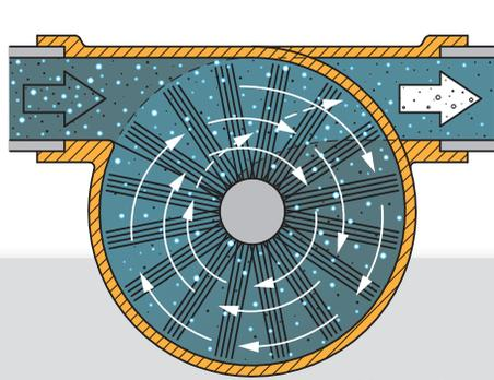
**Konventioneller Abscheider mit komplettem Durchfluss: Geringe Abscheidung von 25 % pro Zyklus.**
