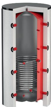
Pufferspeicher für geschlossene Warmwasserheizungsanlagen mit fest eingeschweißtem Glattrohrwärmetauscher zur hydraulisch getrennten Einbindung zusätzlicher Heizsysteme (z.B. die Kombination von Feststoffkesseln mit Solaranlagen o.ä.). Robuste und montagefreundliche Konstruktion. Ausgerüstet mit diversen Fühleranschlüssen zur individuellen Einstellung der Temperaturregelung. Fußhöhenverstellung für schnelles und sicheres Ausrichten. Außen Pulverbeschichtung, innen roh.
