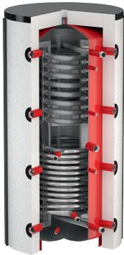
Speicher zur Kombination mehrerer Heizsysteme wie Feststoff-, Öl- bzw. Gaskessel, Wärmepumpen und Solaranlagen in Verbindung mit hygienischer Trinkwassererwärmung im integrierten, großflächigen Edelstahlwellrohr-Wärmetauscher. Solareinbindung über fest eingeschweißten Glattrohrwärmetauscher. Pufferteil innen roh und außen mit temperaturbeständiger Beschichtung. Fußhöhenverstellung für schnelles und sicheres Ausrichten. Robuste und montagefreundliche Konstruktion.
